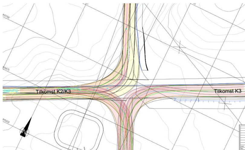
Figur 77 Køyrmåte C, internkryss på KBA3 og KBA4
