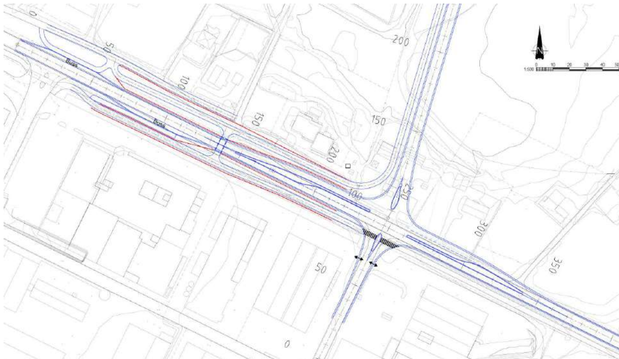
Forslag til utforming av forkjøringsregulert X-kryss (her vist med undergang)
