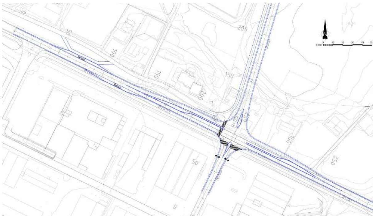
Forslag til lysregulert kryssing i plan for myke trafikanter (her vist med X-kryss)
