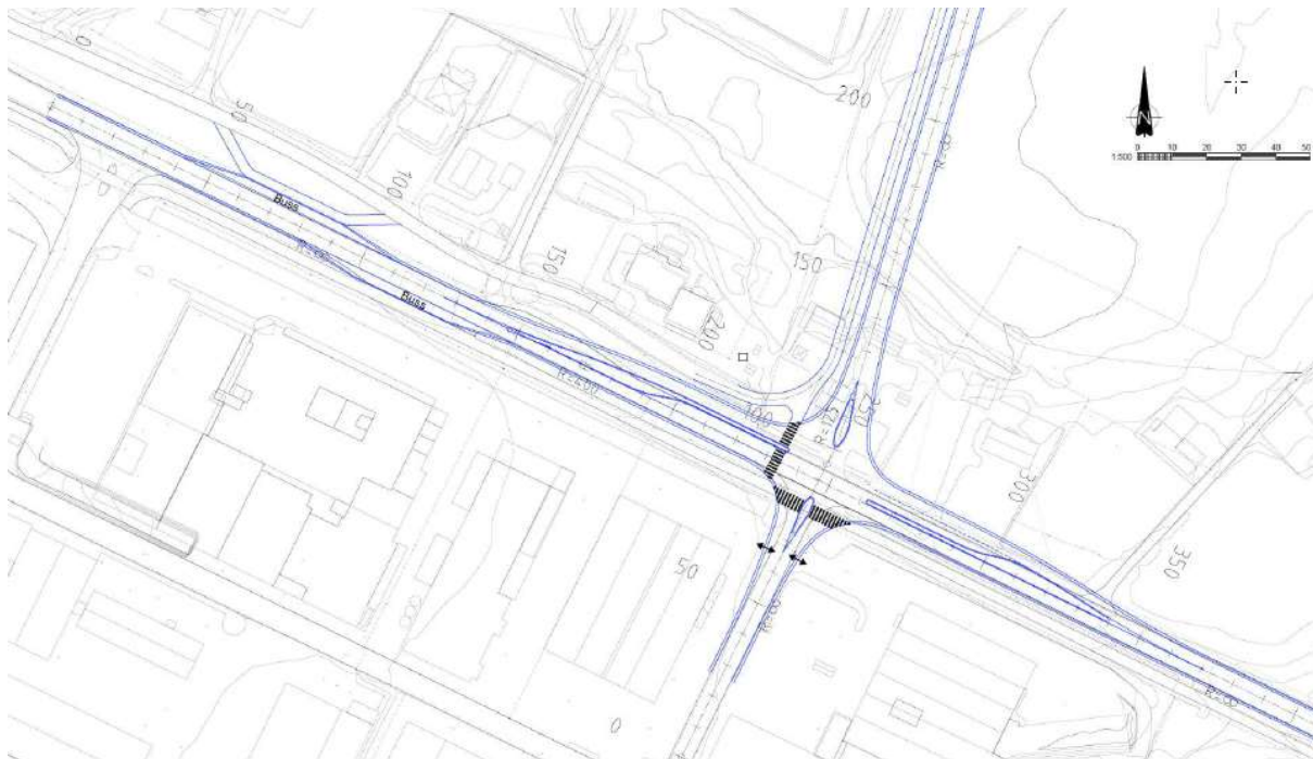
Forslag til lysregulert X-kryss (her vist med kryssing i plan for myke trafikanter)
