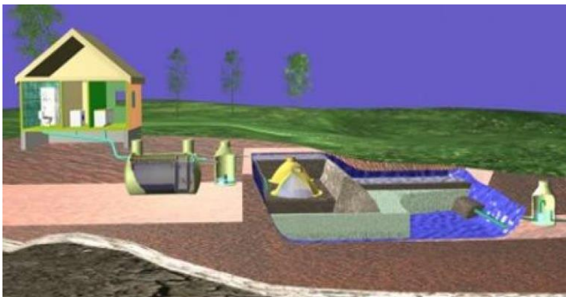
Figur 4. Prinsskisse av et filterbedanlegg/våtmarksanlegg (figur fra www.avlop.no )
