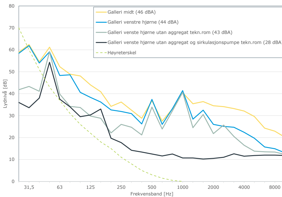
Figur 7. Målte støynivå fra bygningstekniske installasjoner i Storsalen. Systematisk kartlegging av støybidrag, øvre del.
