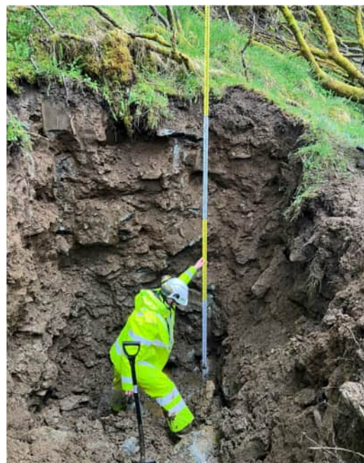
Figur 7 Bilde fra prøvegravning i pkt. E17 (tv) og E47 (th) som viser mer enn 50% innhold av stein og blokk.
