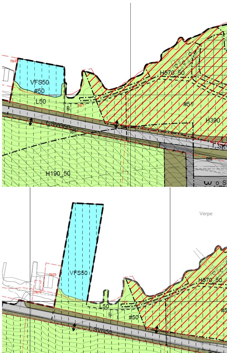
Figur 5.3. Plassering av drenering ut frå tunell i vedteken plan (øvst) og i endra plan (lengst ned)
