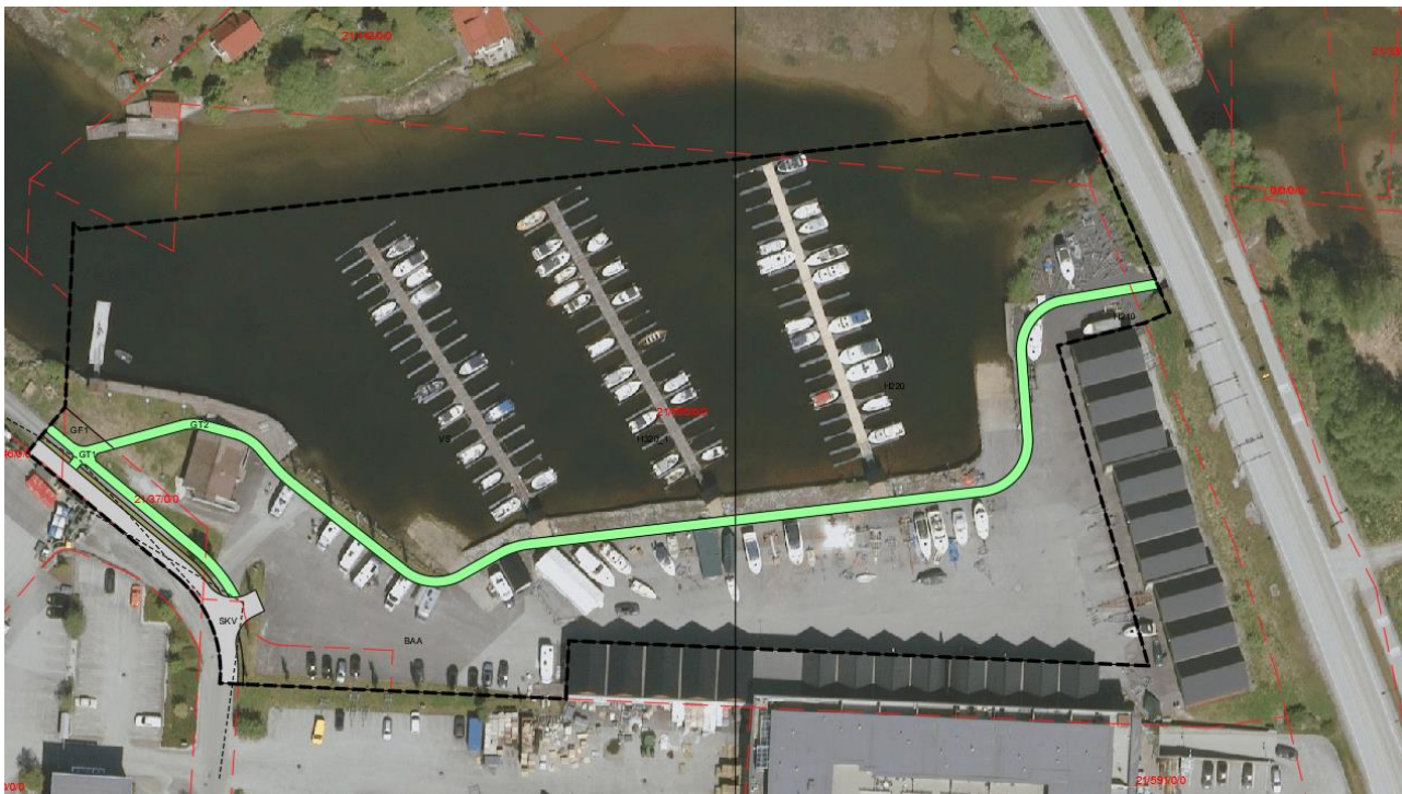
Figur 3.1: Ortofototoet syner tilkomst frå Firdavegen til området. Tilkomsten er dimensjonert for lastebil.
