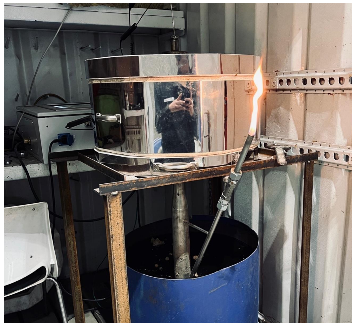
Forsøk i småskala batch pyrolyseovn (2023 / 24)
