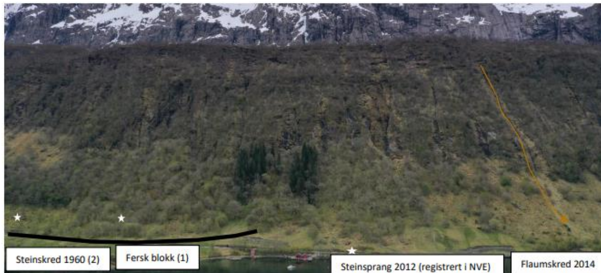
Figur 7: Figur hentet fra Asplan Viak sin rapport med retning mot sør (Asplan Viak, 2021) og plassering av skredhendelser lang vegstrekning vurdert av Asplan Viak (markert med svart strek). Ny planlagt veglinje går mer mot sør enn svart veglinje i figur.
