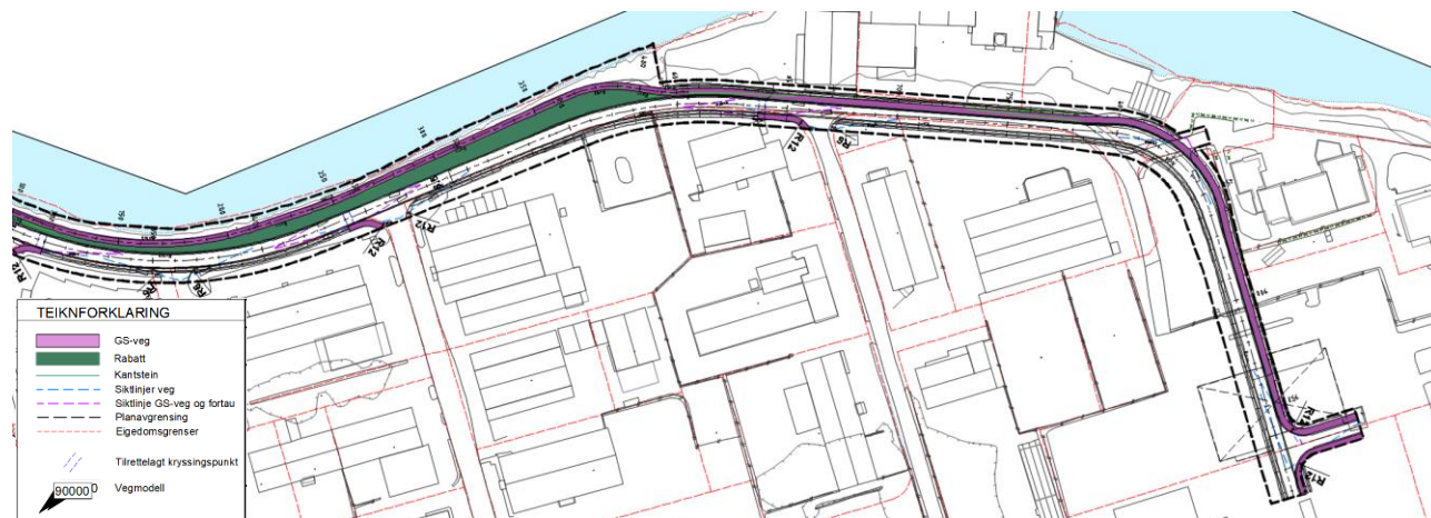
Figur 3.2: Figuren syner hovudprinsippet for utforming av gang- og sykkelvegen langs veg Øyrane. Punkta for tilrettelagt kryssing er synt i vedlagt detaljteikning E10 og E11.
